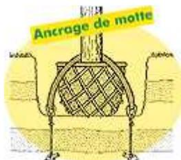
Cette technique permet de maintenir fermement dans le sol la motte de l'arbre à replanter. Elle se substitue au traditionnel tuteurage bois. Invisible, l'ancrage de motte permet d'obtenir non seulement un bon maintien du végétal avec une finition esthétique appréciable mais aussi permet d'en limiter le vol et facilite son entretien futur.
