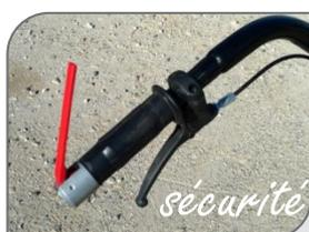
interrupteur de coupure
