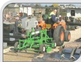
Les combinaisons griffes / lames / tapis et les roues silencieuses des différents rabots permettent un travail efficace et soigné sur beaucoup de supports perméables sans déstructurer en profondeur. La finition est réalisée par un tapis maillé. Le RD peut être équipé d'un rouleau et de coupes bordures circulaires. Selon les modèles, largeurs et montages choisis, le RD s'adaptera à vos surfaces.
