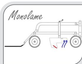
Le RDE, possède un châssis roulant muni d'un outil mono-lame doublé d'une herse à 2 rangs. Il est aussi équipé du tapis de finition et peut être livré avec coupes bordures et rouleau.
